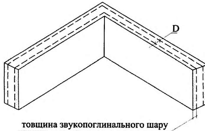
Рисунок Д.1 – Схема прямокутного повороту повітропроводу
